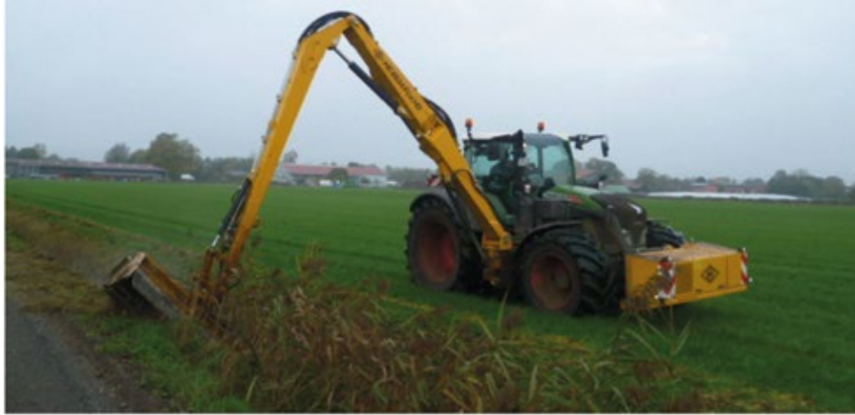
Mähausleger mit auswechselbaren Arbeitsgeräten wie: Mähkorb, Mähbalken und Schlegelmäher
