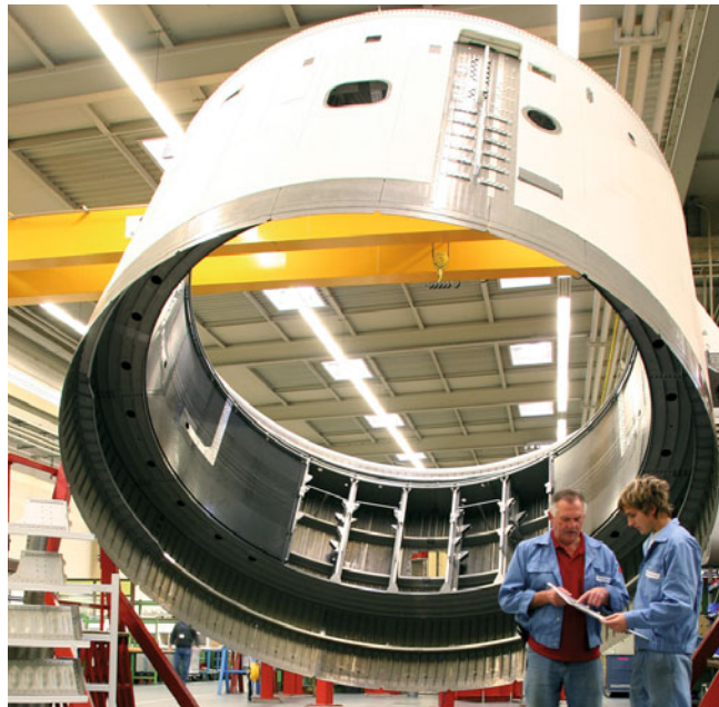
Schwebend in der Halle von „MT Aerospace“: Die wichtigste Schubstruktur der Ariane wird sich einmal zwischen der Zentralstufe und der Oberstufe befinden.
